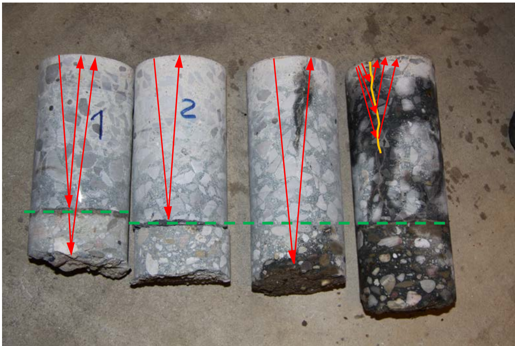
Abbildung 5: Reflexionshorizonte des Ultraschall-Echos, dargestellt an den entnommenen Bohrkernen für die Fälle von schwachem (Bohrkern 1), fehlendem (Bohrkern 2) bzw. homogenem (Bohrkern 3) Verbund zwischen Bodenplatte und Sauberkeitsschicht sowie im Falle von gestörten Messungen bei sehr breiten Rissen (Bohrkern 4)
