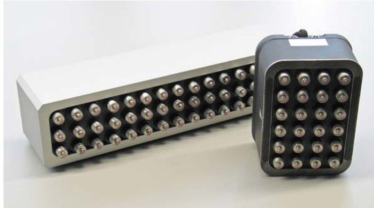
Bild 3. Ultraschall-Prüfkopfarray mit 48 Prüfköpfen in 16 Gruppen (links) und einkanaliger Prüfkopf mit je 12 Sende- und Empfangswandlern (rechts)
