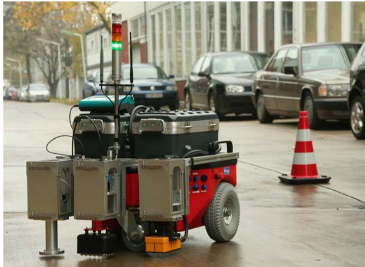
Abbildung 2: Roboterplattform mit Sensorik (Wirbelstrom, Mikrowellen-Feuchtemesser, Ultraschallarray, Radar)
