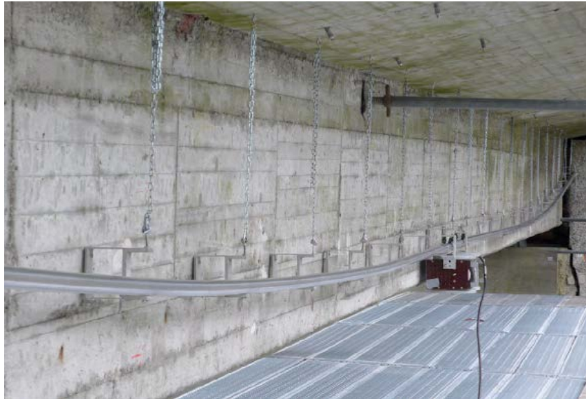
Bild 4. Die typische Arbeitsweise an einem Spannbeton-Brückenträger ist das Magnetisieren entlang des parabelförmig verlaufenden Spannglieds mit der gleichzeitigen Messung der magnetischen Flussdichte im aktiven Feld und/oder mit einer zusätzlichen Messung im remanenten, das heißt bleibenden Feld.
