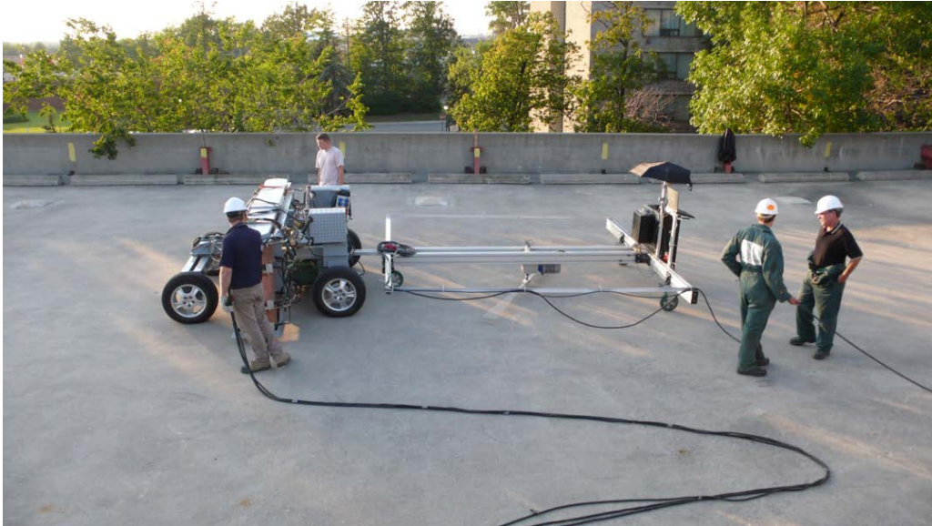
Bild 8. Messtechnik auf einem Parkdeck mit Rotationsscanner und Magnetwagen.
