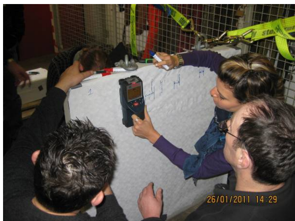
(a) Abbildung 4 (a) Einzeichnen der detektierten Bewehrung; (b) Ergebnis der Bewehrungsortung mit „Schriftbild“ nach Verfahrensanweisung.
