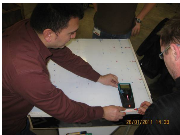
(a) Abbildung 3 (a) Messung am Demoblock im Blindtest; (b) nach der Messung freigelegte Bewehrungsanordnung.
