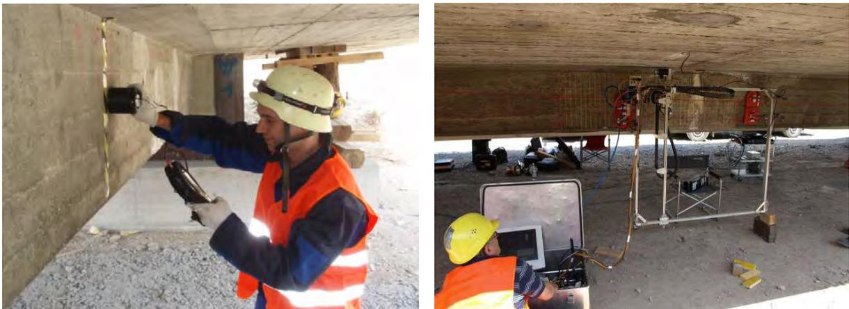
**Abbildung 7:** Ultraschallechomessungen, links von Hand entlang einer Messspur, rechts mit einem Scannersystem der BAM.
