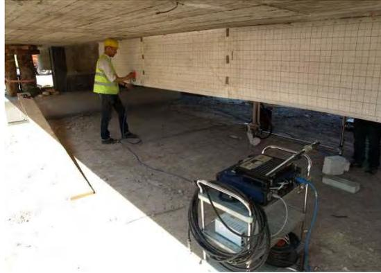
**Abbildung 8:** Radarmessung an der Seitenfläche (Kappenseite) des Längsträgers
