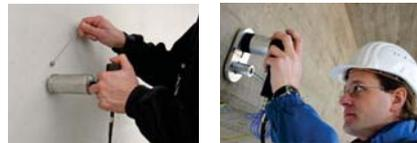
Beispiele für Impakt-Echo-Prüfeinrichtungen mit manueller (links) und elektromechanischer (rechts) Auslösung
