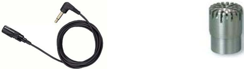
Abbildung 5: Beispiele für einsetzbare Mikrofontypen. Links: Elektret-Kondensatormikrofon mit einem Frequenzgang von 50 - 16000 Hz, rechts: Präzisionskondensatormikrofon mit einem Frequenzgang von 4 - 20000 Hz.
